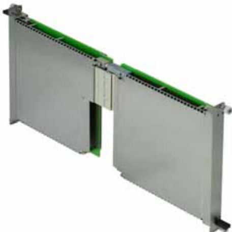
La figure montre le module MTCA.4 AdvancedMC avant et RTM avec le couvercle MTCA.4
